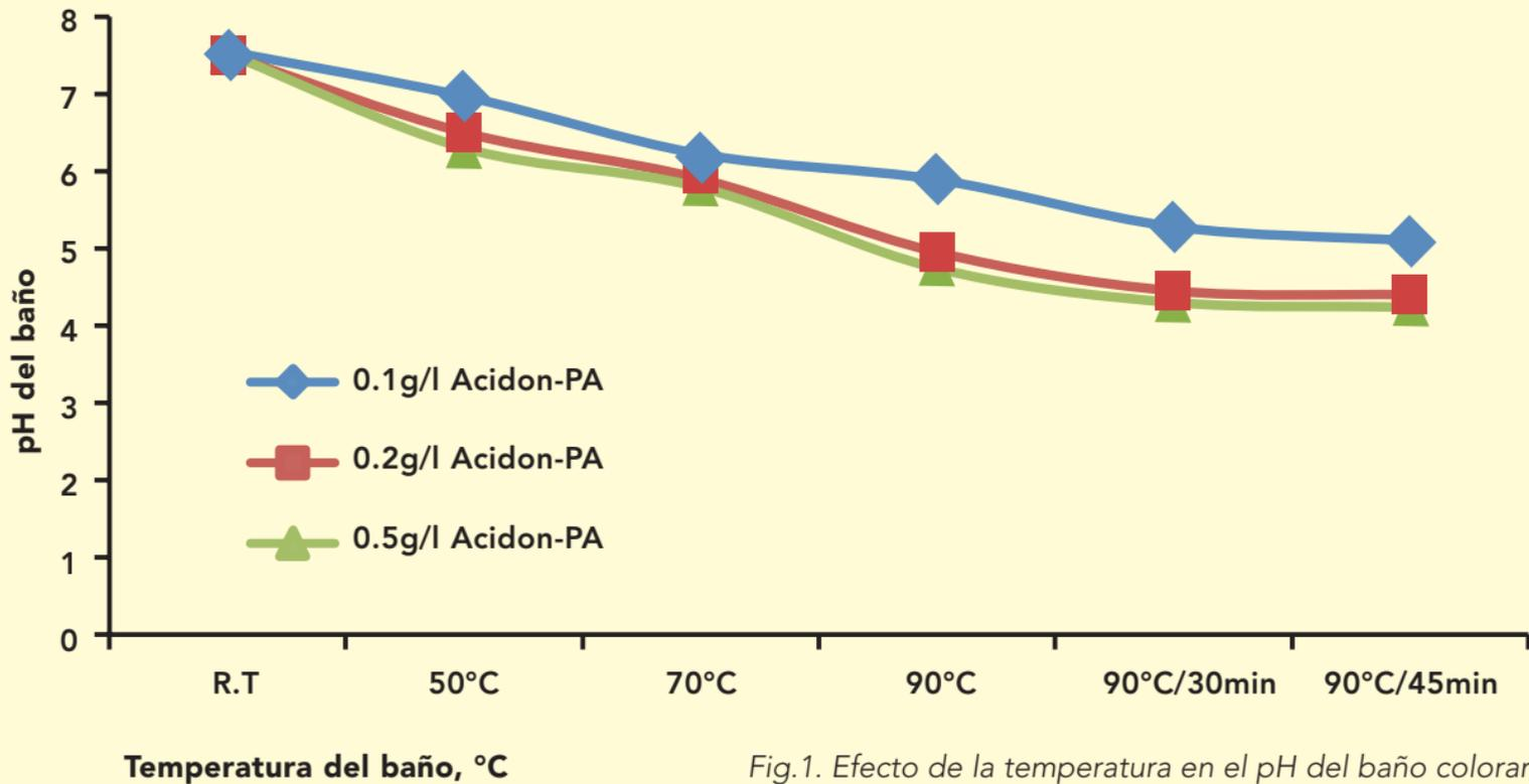
Fig.1. Efecto de la temperatura en el pH del baño colorante usando Acidon-PA en varias concentraciones.
